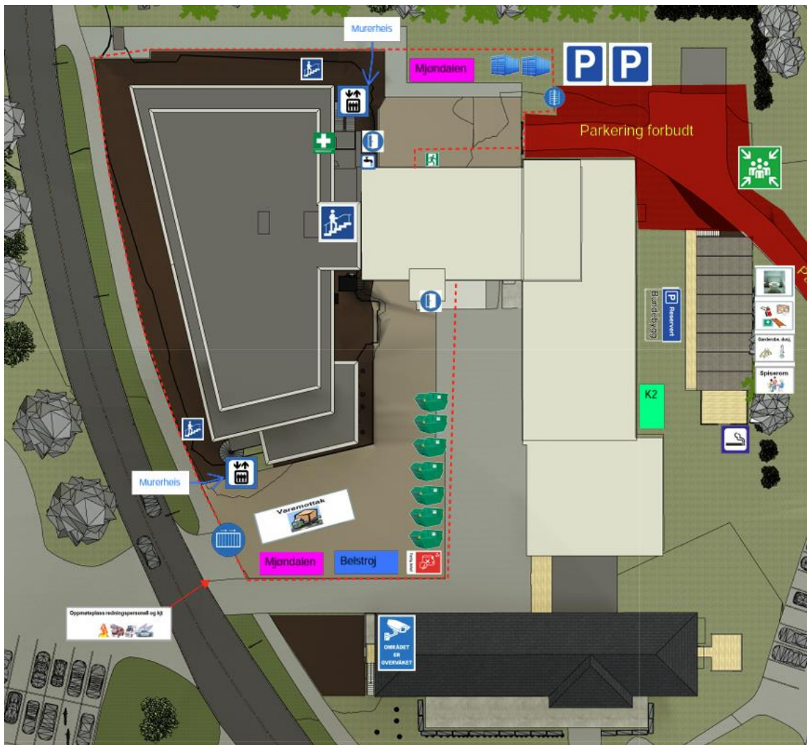
Riggplan 3.etappe (Tett bygg og innredning)
