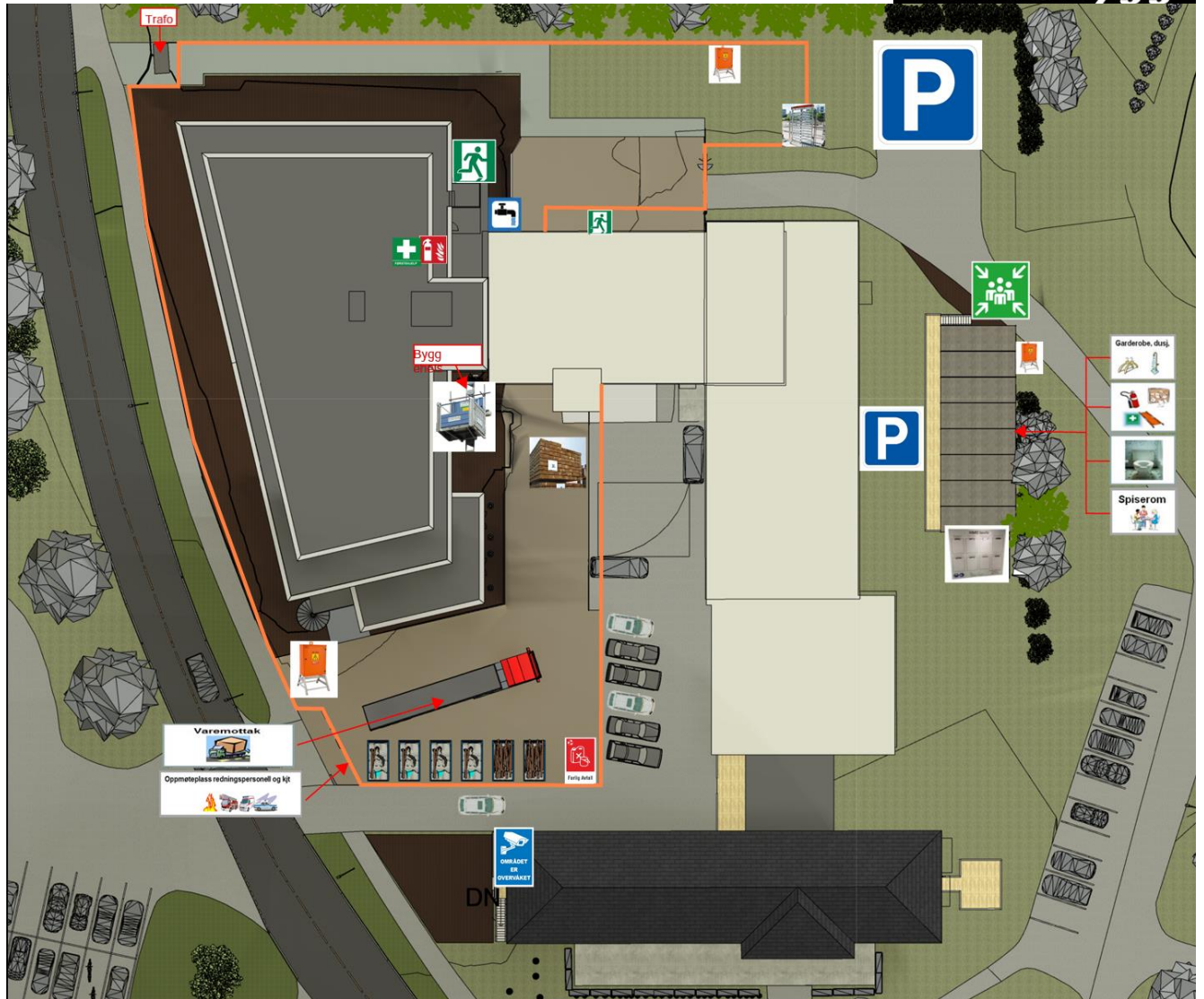
Riggplan 3.etappe (Tett bygg og innredning)
