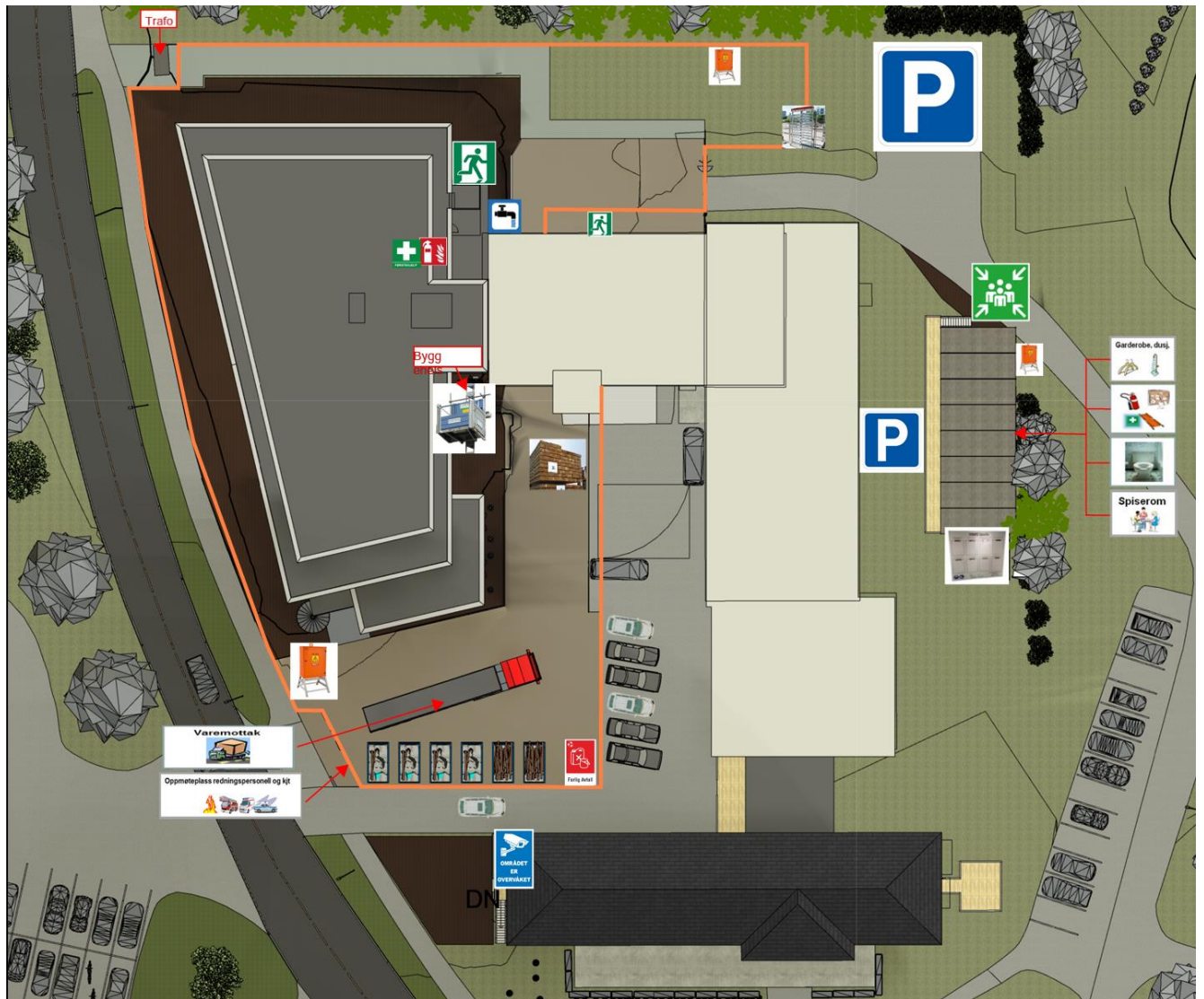
Riggplan 3.etappe (Tett bygg og innredning)
